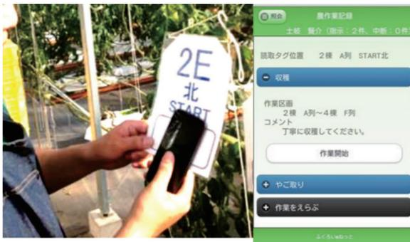
図 1 NFC タグを用いた農作業記録
